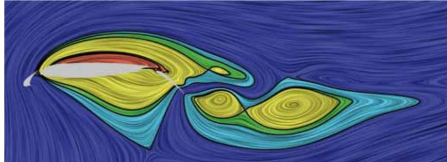
Automatisch ermittelte Wirbelregionen am Modell eines Flugzeugflügels; die Hierarchiestufen sind durch Einfärbungen kenntlich gemacht.
