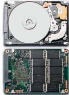
In der Abbildung ist eine SSD mit den Flash-Speichereinheiten und dem Controller gezeigt. (Quelle: [ssd-solid-state-drive.net](http://ssd-solid-state-drive.net))
