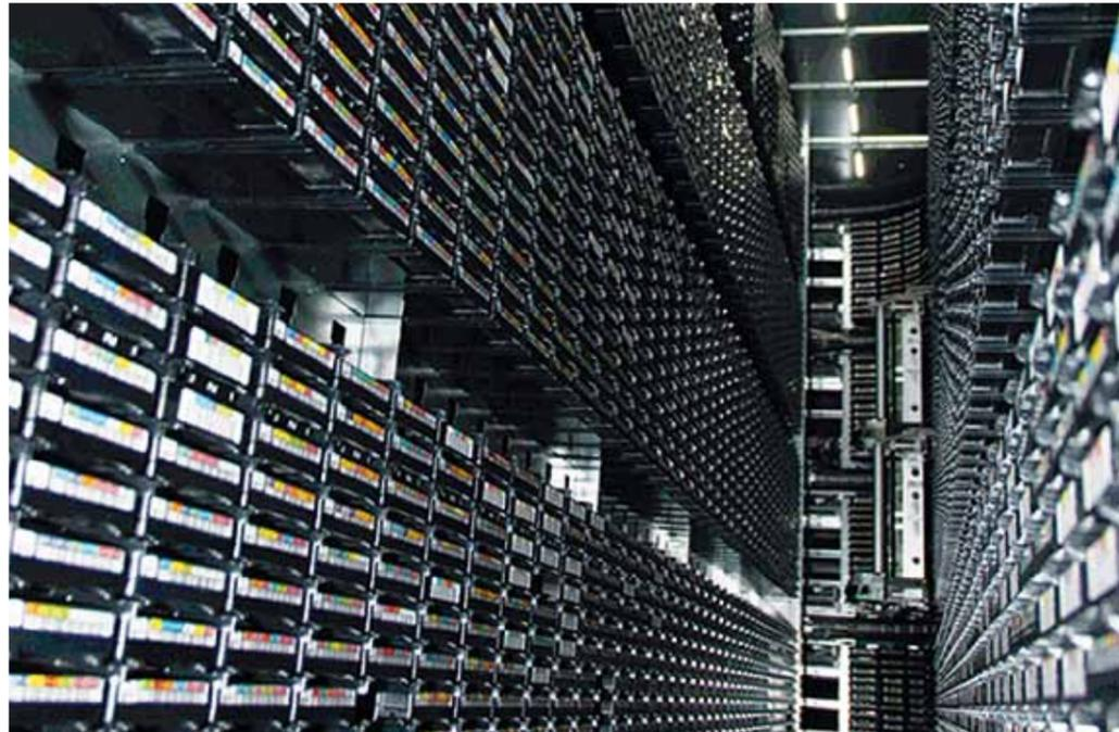
Das Bild zeigt einen der Gänge im Bandarchiv, in dem auf den Seiten die Bandkassetten in Fächern abgelegt sind. Der Transport der Kassetten von ihren Fächern zu den im Hintergrund erkennbaren Bandlaufwerken erfolgt durch Roboter.
