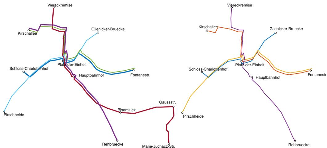
**Abbildung 4:** Tramlinien, die sich in der Optimallösung von Szenario 2 (links) und Szenario 3 (rechts) unterscheiden. Links die besten Linien für weniger Restriktion, die dicken Linien fahren im 20-Minuten Takt, alle anderen im Stundentakt. In der rechten Abbildung verkehren alle Linien im 20-Minuten Takt.
