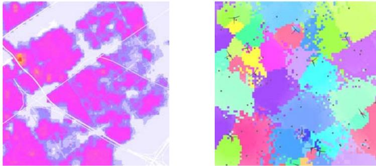
ABBILDUNG 2.35: Für die dargestellte Lastkarte (links) wurde das Netz mit der dargestellten Zellenkonfiguration (rechts) berechnet (*best server* Karte). In den Gebieten mit höherer Lastvorhersage (Nordwesten) sind die Zellen erkennbar kleiner.
